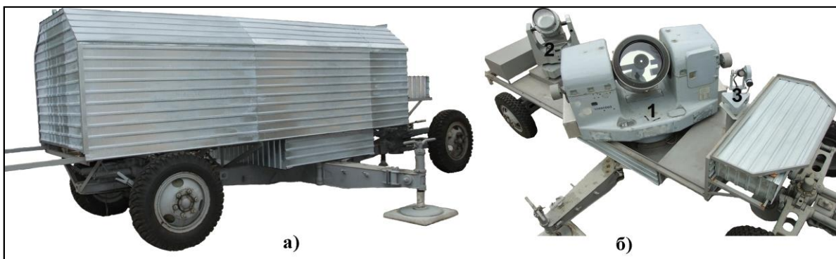
Рис. 8. Зовнішній вигляд комплексу телескопів МОБІТЕЛ а) укриття телескопа, б) платформа з телескопами.
